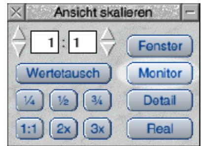
Bei Anklicken mit ADJUST folgt die Größe des Anzeigefensters der Skalierung der Ansicht.
